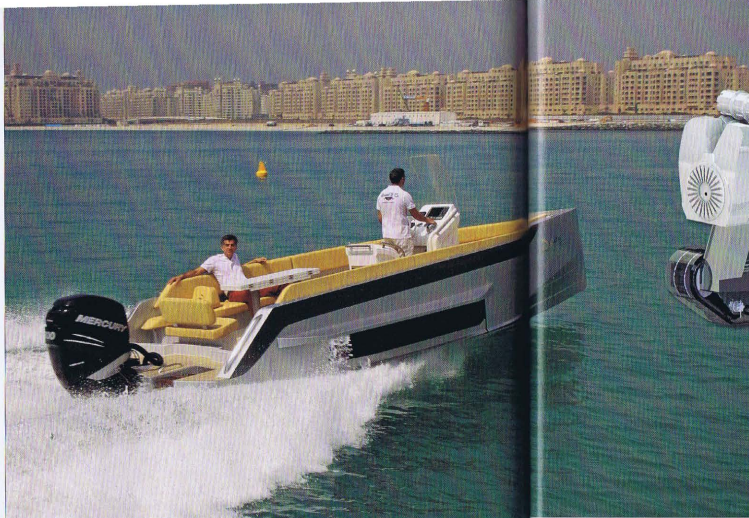
En mode navigation, les chenilles intégrées dans leur niche font partie intégrante du bordé et ne nuisent pas à l'esthétique du bateau.
